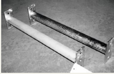
Bild 1: Feuerverzinkung unterschiedlicher Stahlqualitäten
