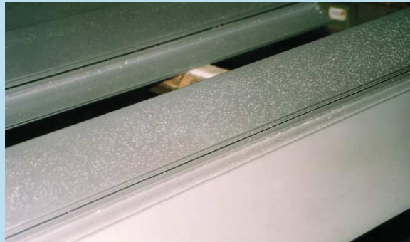
Die Spannungsrisse sind an großen Winkelprofilen während der Zuschnittarbeiten beim Metallbauer aufgetreten
