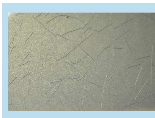
Spannungsriss in einem bewusst untervernetzten Pulverklarlack auf Metallic-Pulverlackuntergrund
