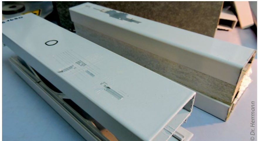
Bild 1: Typisches Schadensbild nach Gitterschnittprüfung an beschichteten Isoliersteg-Profilen eines namhaften Profil-Herstellers
