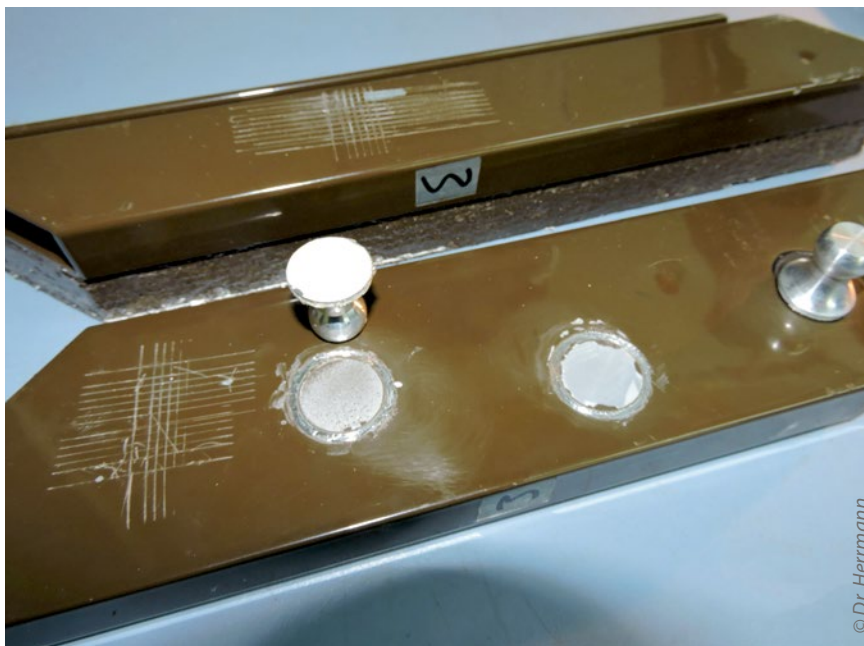
Bild 6: Stempelabrissprüfung (ammoniakalische Vorbehandlung im Tauchverfahren)
