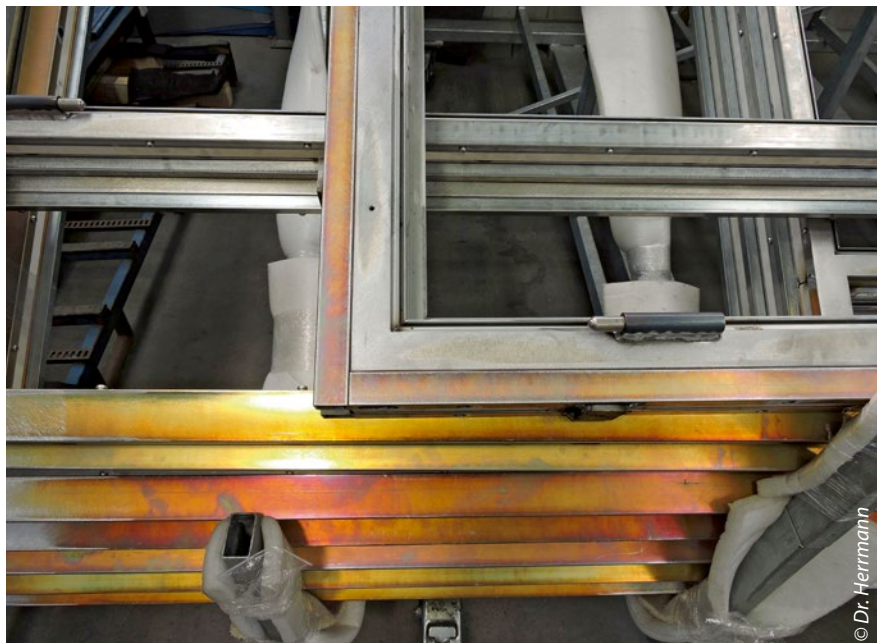
Bild 2: Oberflächenqualitäten im Vergleich: Gelb-chromatierte Substrate und neue Verzinkungsqualität.
