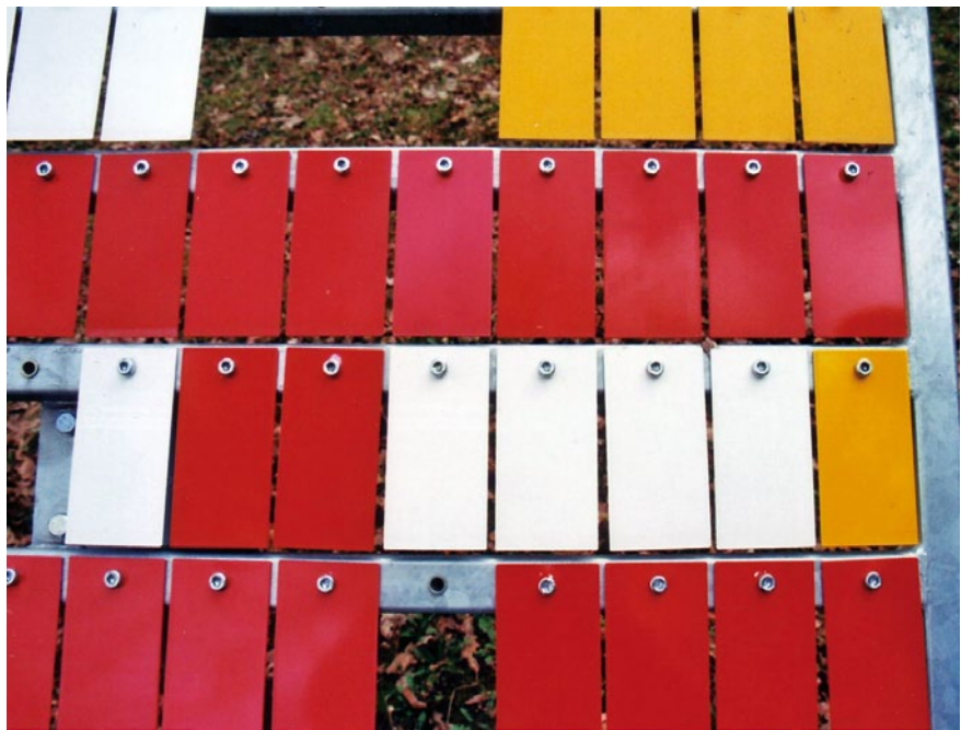
Freibewitterungsstand mit pulverlackierten Proben zur Untersuchung des Langzeitverhaltens der antimikrobiellen Wirkung und Bewitterungsstabilität
