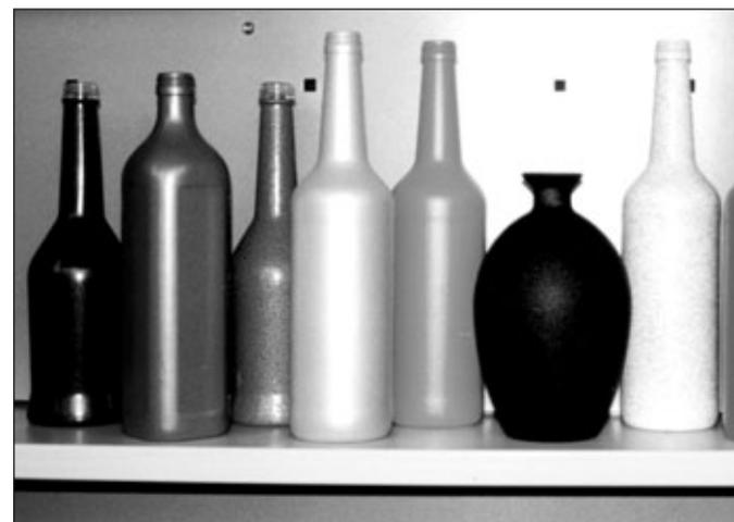
**Die Beschichtung von Glasflaschen lässt sich mit verschiedenen Effektpulverlacken realisieren.**
