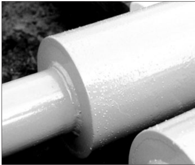
Ausgasungen im Pulverlackfilm bei stückverzinkten Walzenkörpern.
