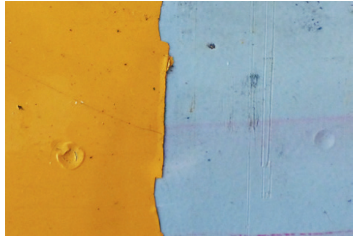
In direkt beheizten Einbrennöfen kann es zur Deckpulverenthaftung von der EP-Grundierung (grau) kommen. Fotos: Dr. Herrmann GmbH
