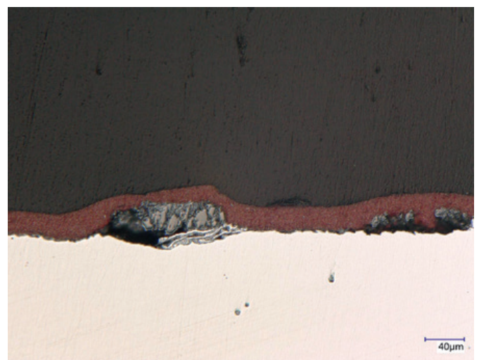
Die mikroskopische Aufnahme des metallographischen Querschliffs offenbart erkennbare Strahlrückstände sowie Zunderreste zwischen Substratoberfläche und Pulverbeschichtung.
