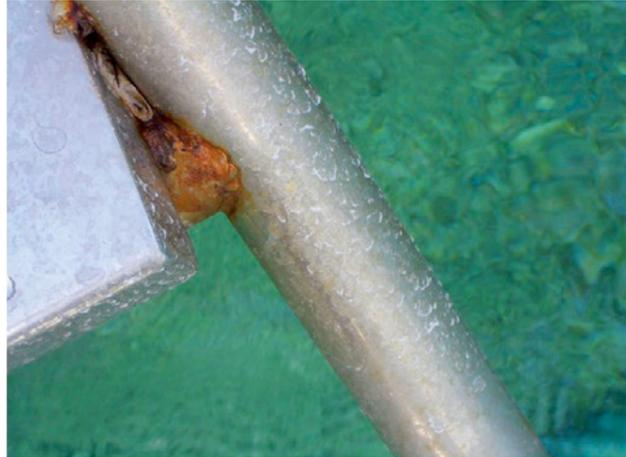
Wenn Edelstahl mit einer unedler legierten Elektrode geschweißt wird, kann es zu verstärkter Korrosion kommen, wie bei diesem Badepodest mit angeschweißter Edelstahl-Trittlfläche am Meer.
