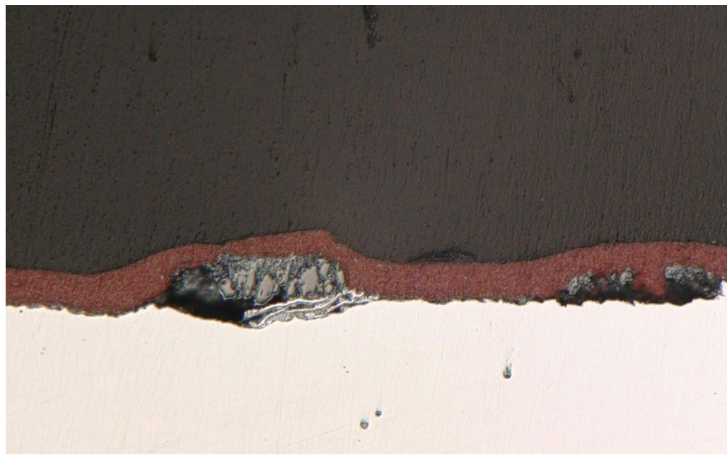
Die mikroskopische Aufnahme des metallographischen Querschliffs offenbart erkennbare Strahlrückstände sowie Zunderreste zwischen Substratoberfläche und Pulverbeschichtung. Abbildungen: Dr. Herrmann GmbH & Co. KG
