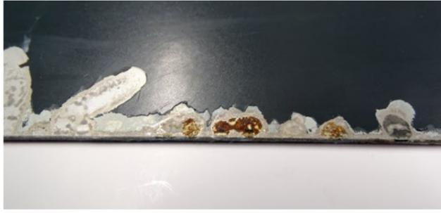
Abb. 2: Galvanisch verzinktes (~5 µm) und pulverbeschichtetes Stahlblech nach Beanspruchung im neutralen Salzsprühnebeltest über 720 h, mit deutlichen Weiß- und Rotrost-Erscheinungen im Bereich der Schnittkanten sowie Lackfilmunterwanderung.
