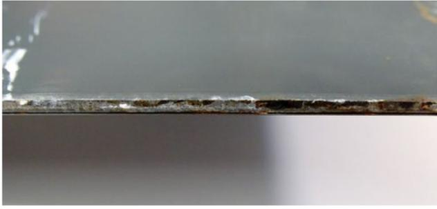
Abb. 1: Galvanisch verzinktes (~5 µm) und pulverbeschichtetes Stahlblech nach Beanspruchung im neutralen Salzsprühnebeltest über 720 h, mit deutlichen Weiß- und Rotrost-Erscheinungen im Bereich der Schnittkanten.
