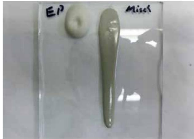
Reaktivitätsprüfung mittels Pillenablauf: Die geringere Reaktivität von Hybridpulverlacken bedingt eine langsamere Vernetzung und somit hat der Lack länger Zeit, um zu verlaufen.
