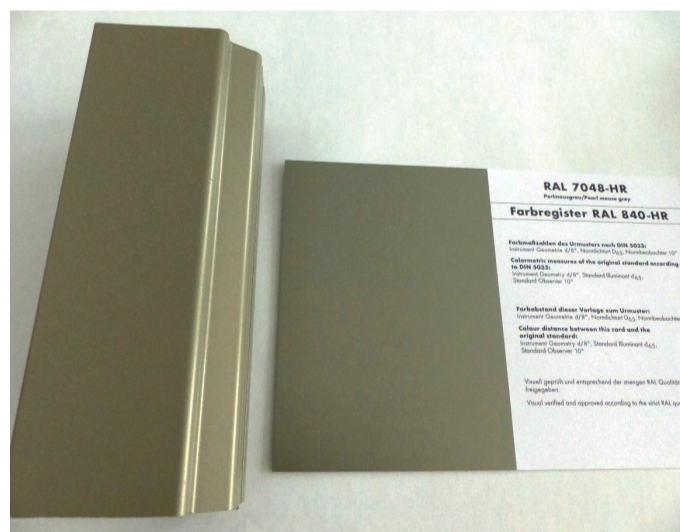
Erkennbare Farbtonunterschiede beim Musterbauteil (li.) und der dazugehörigen zertifizierte RAL-Karte 7048-HR.
