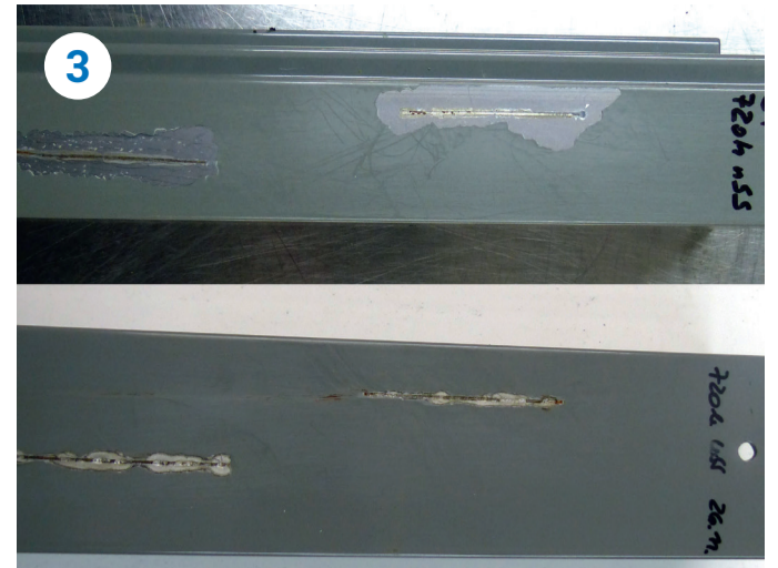
3 Abb. 3: Große Unterschiede stelle das Labor bei der Lackunterwanderung am Ritz aufgrund unterschiedlicher Vorbehandlung (nach 720 h nSS-Test) fest; oben: zu starke Beizentfettung + Eisenphosphatierung; unten: alkalische Entfettung + Zinkphosphatierung.
