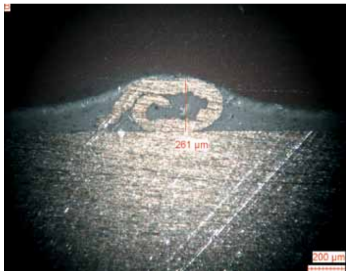
Der im Querschliff sichtbare Aluminiumspan aus der Oberflächenbearbeitung ist mit dem Substrat fest verbunden.
